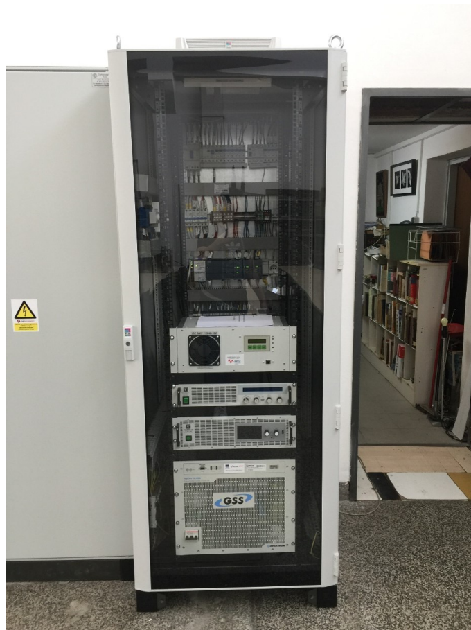
Slika 3.13: SGLab - istosmjerna mikromreža i elektronički tereti.
