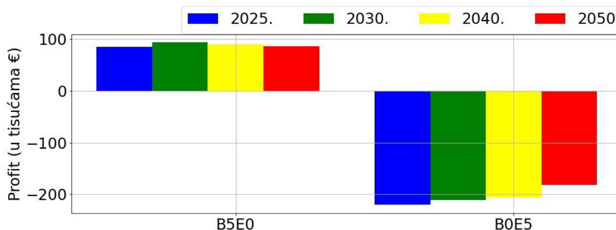
Slika 2 Profiti baterijskog sustava (lijevo) i elektrolizatora (desno) po godinama za priključnu snagu od 5 MW – CO 2 model arbitraže
